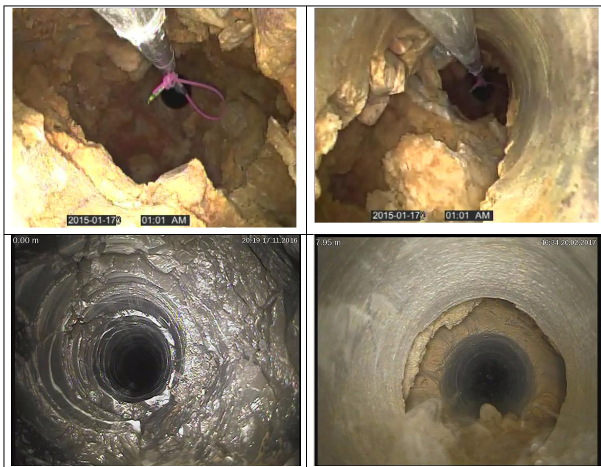
Obr. 15 Fotografie pořízené při dokumentacích vrtů: Horní dva obrázky představují zastížené zkrasování, levý dolní poruchovou zónu v břidlicích a pravý dolní je záznamem ze zvodnělého vrtu v místě přítoku vody do vrtu z otevřené pukliny
