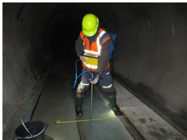
Obr. 5 Meranie prietoku v odtokovom žľabe prieskumnej štôlne a prítok vody STR Fig. 5 Measurement of flow in the drainage trough of the exploration gallery and water inlet STR Zdroj: Coplák, M., et al. 2018, CAD-ECO, a.s., Bratislava
