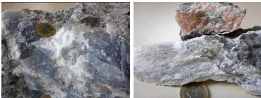
Obr. 12, 13 Detail anhydritu a sádrovce (vláknitá a masivní (růžová) varianta). Langer Berg Figs. 12, 13 Detail of anhydrite and gypsum (fibrous and solid (pink) variant). Langer Berg 1
