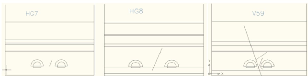
Obr. 8 Rôzne výpočtové modely na určenie vplyvu trhlín na stabilitu stredového piliera Fig. 8 Various computational models to determine the impact of cracks on the stability of the center pillar
