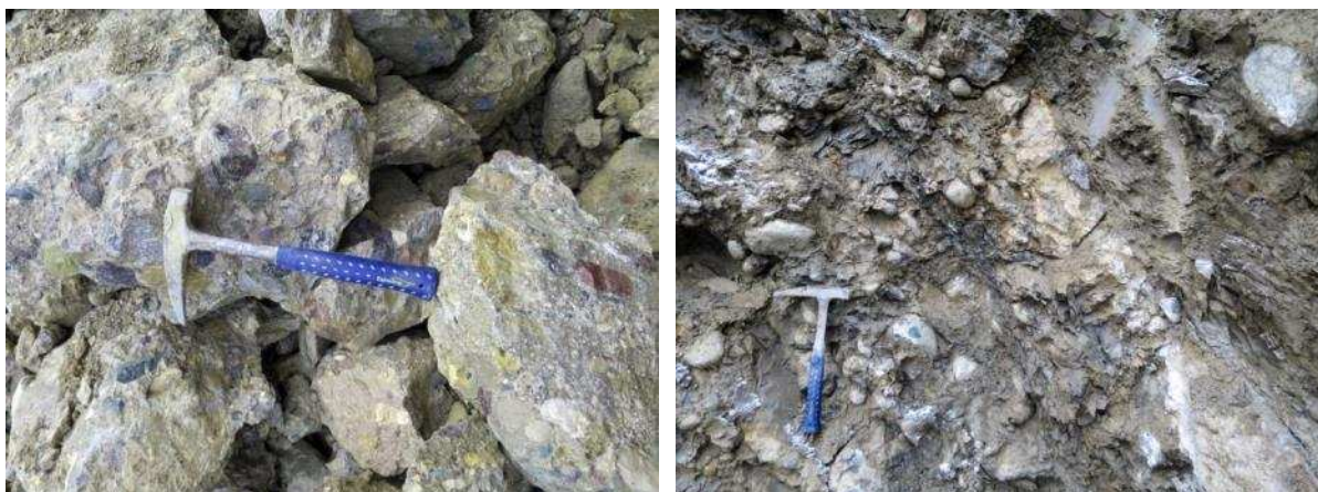
Obr. 2 Polymiktní slepence s vápnito-písčitým tmelem s vysokou pevností a odolností vůči zvětrávání (vlevo); slepence s jílovito-slinitým tmelem s polohami slínovců (vpravo).
