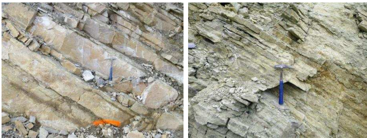
Obr. 3 Deskovité až lavicovité pískovce se střední až vysokou pevností (vlevo); tenké deskovité polohy slabě vápnitých prachovců až jílovců nízké pevnosti (vpravo).
