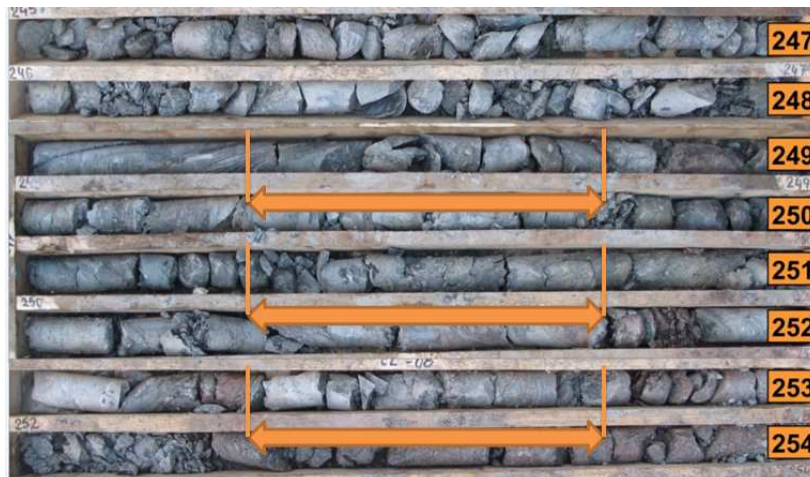
Obr. 4 Vrtné jadro z vrtu CZ-08 z úseku 247,0 – 254,0 m. Vyznačené polohy dilatometrických skúšok s modulom deformácie E_{\text{def}} = 20,39 - 24,95 MPa Fig. 4 Core recovery of borehole CZ-08 from the depth 247.0 – 254.0 m. Indication of dilatometric tests with modulus of deformation E_{\text{def}} = 20.39 - 24.95 MPa
