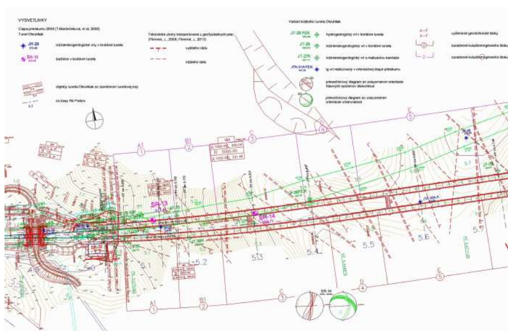
Obr. 3 Účelová inžinierskogeologická mapa (tektonická nerovnorodosť) – západná časť Fig. 3 Specialized engineering geological map (tectonic heterogeneity) – West part
