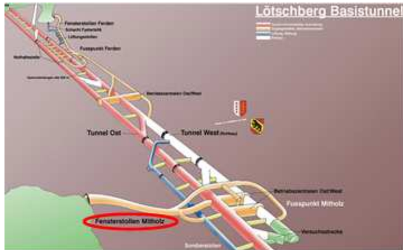
Obr. 1 The Lötschberg hlavný tunel vo Švajčiarsku s bezpečnostným tunelom Mitholz (BLS Alp Transit AG)
