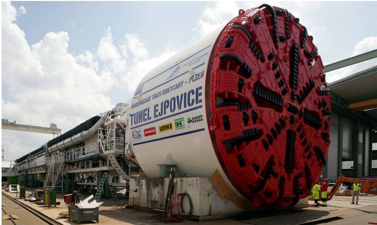
Obr. 3 Tunelovací stroj S-799 v továrni firmy Herrenknecht Fig. 3 Tunneling machine S-799 in production factory Herrenknecht
