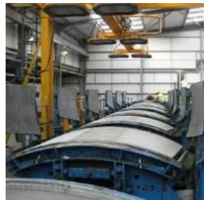
Výroba segmentov v Morgan EST factory Ridham Dock in Kent
