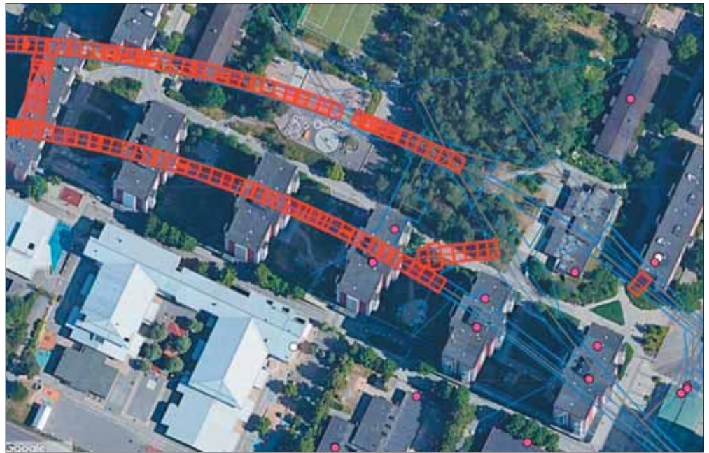
Obr. 9 Situace postupu ražeb v blízkosti stanice Akalla (26. květen 2022) Fig. 9 Plan of the progressing excavation in the vicinity of Akalla station (26 May, 2022)
