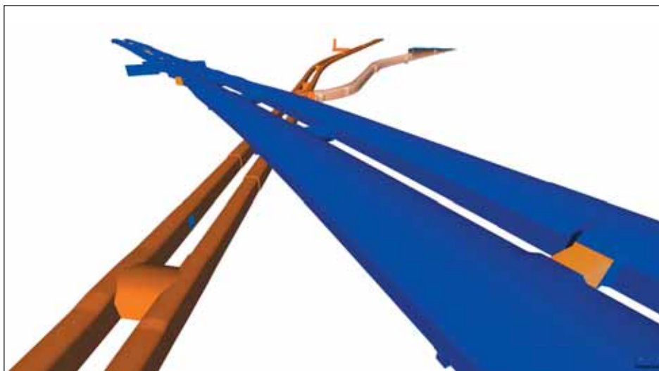
Obr. 5 Vizualizace podchodu traťových tunelů (oranžová) pod tubusy stávajícího dálničního obchvatu Forbifarten (modrá)
