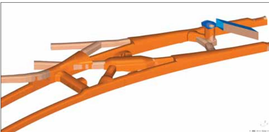
Obr. 10 Vizualizace ražeb v blízkosti současné stanice Akalla; v místě, kde na pravé straně obrázku „končí“ model (staničení 15+300), se už nachází nástupiště Fig. 10 Visualisation of excavation in the vicinity of Akalla station; in the place where the model ends on the right side of the picture (chainage 15+300), there is already the platform there
