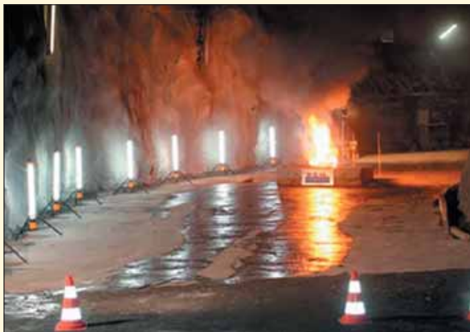
Obr. 1, 2 Hořící modul baterie Li-on Fig. 1, 2 Burning Li-on battery module
