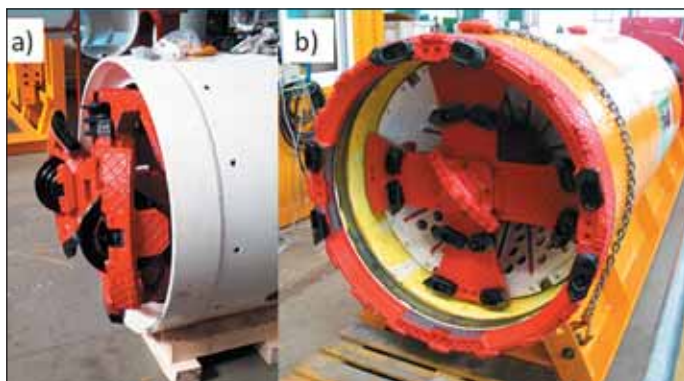
Obr. 10 a) První možnost zatahovacího mechanismu stroje M-SPB se skloupnou řeznou hlavou b) Druhá možnost zpětného vytahování stroje M-SPB se ztracenou vnější obručí hlavy
