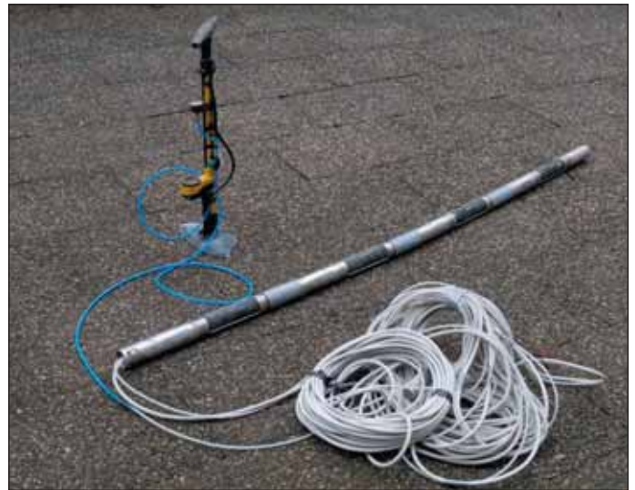
Obr. 2 Čtyřstupňový tříložkový seismický snímač do vrtu – INSET Fig. 2 Four-stage, three-component seismic borehole sensor – INSET
