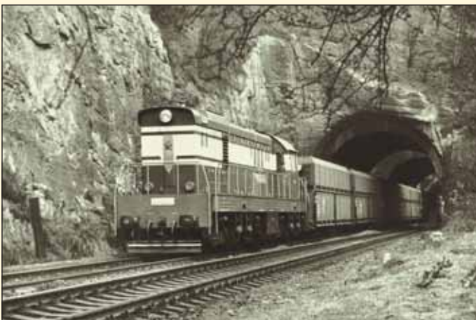
Obr. 1 T 669.0096 Dieselelektrická víceúčelová lokomotiva Co' Co'. Výrobek lokomotivky v Dubnici n. Váhom z roku 1968. Nakladatelství PressFoto Praha. Foto © Pavel Vančura. Cca 1975. [sbírka autorů]
