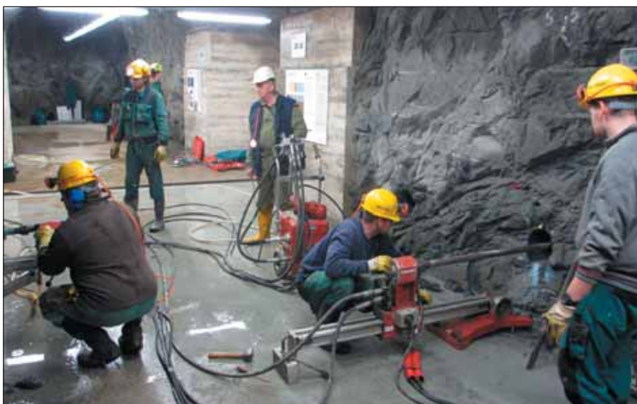
Obr. 4 Příprava vrtů pro interakční experiment Fig. 4 Preparation of boreholes for the interaction experiment
