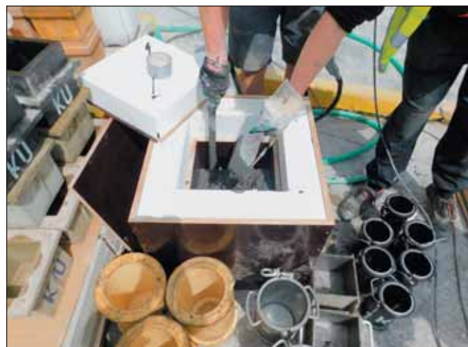
Obr. 2 Příprava tělesa pro měření tepla během hydratace Fig. 2 Preparation of a sample for temperature measurement during hydration
