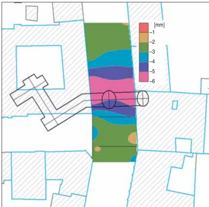
Obr. 11 Hysometrie hodnot svislého posunu bodů na terénu v ul. Václavská v období 6/2019 až 11/2019
