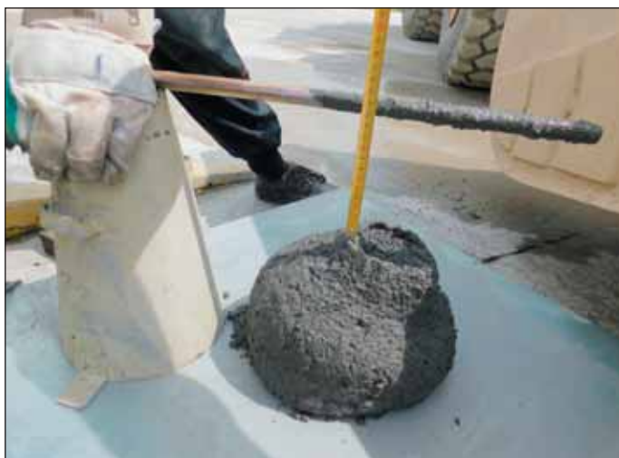
Obr. 1 Zkouška sednutí kužele finální směsi Fig. 1 Cone slump test of the final mixture
