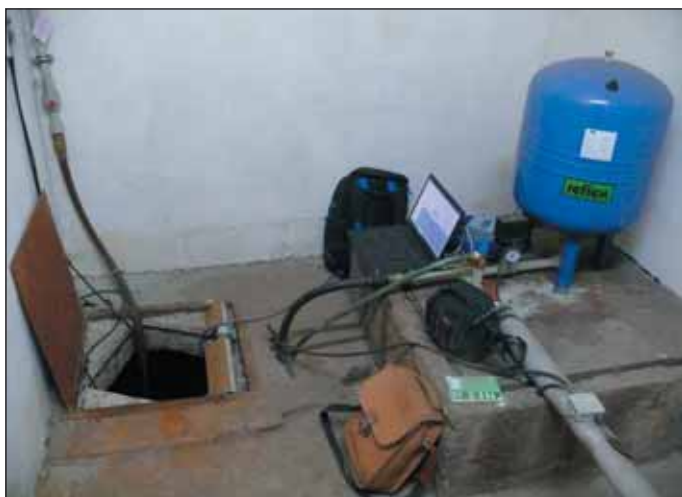
Obr. 13 Odečet piezometrických dat hladiny podzemní vody ve studni v suterénu objektu Václavská 2069/18
