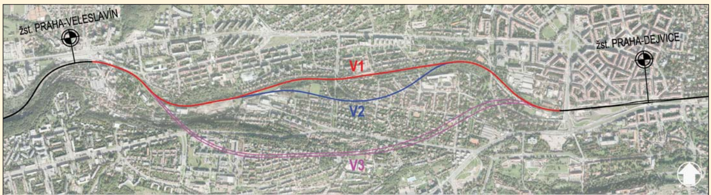
Obr. 1 Varianty podpovrchového vedení trasy v úseku Praha-Dejvice – Praha-Vešlavín, V1 hloubený tunel ve stávající stopě, V2 hloubený a ražený tunel v částečně nové stopě, V3 ražený tunel v nové stopě
