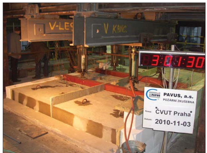
Obr. 11 Stav ostění po 180 minutách – minimální deformace
