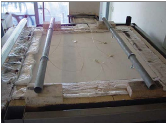
Obr. 2 Zavěšení zkušební panelu v průběhu zkoušky Fig. 2 Hanging a test board during the course of the test
