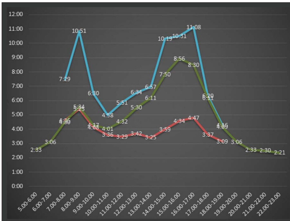
Obr. 11 Doby jízdy v úseku Čínská – Dejvická; před otevřením TKB 14.–18. 9. (červená); po otevření 21.–25. 9. (modrá), 9.–13. 11. (zelená)
