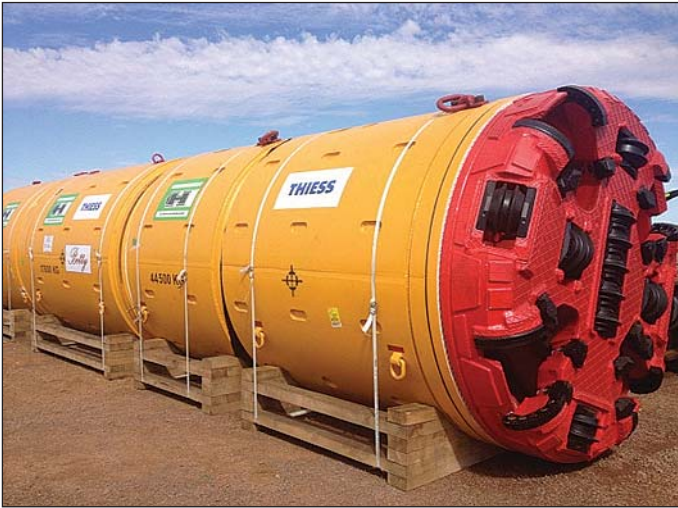
Obr. 11 Bentonitový štít Herrenknecht AVND 2000 AB na stavbě Fig. 11 Herrenknecht AVND 2000 AB TBM at the Project Site
