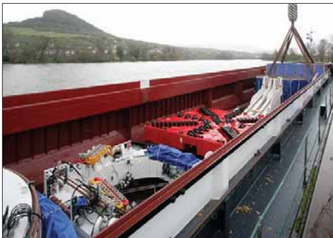
Obr. 1 Doprava štítu po vodě Fig. 1 Shipping of the shield on a river
