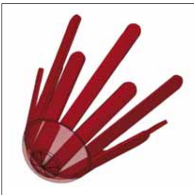
Obr. 8 Blokováci pružina pro počínovou nálož s rozbuškou
