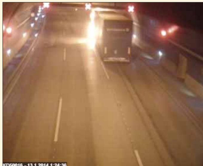
Obr. 1 V čase 1:24 zachvátil požár celou kabinu, světelné signály Stůj svítí, stejně jako osvětlení nouzových únikových cest a hlavní osvětlení je na plný výkon (pohled z kamery CCTV)
