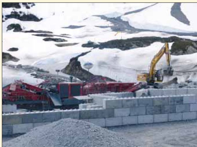
Obr. 8 Drtička a třídička rubaniny vhodná pro výrobu betonu
