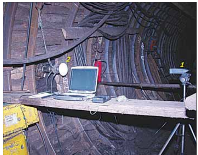
Obr. 1 Ilustrační fotografie systému měření při realizaci tahové zkoušky se záznamem do PC (legenda: 1 – laserový dálkoměr, 2 – tahoměr na instalovaném svorníku)
