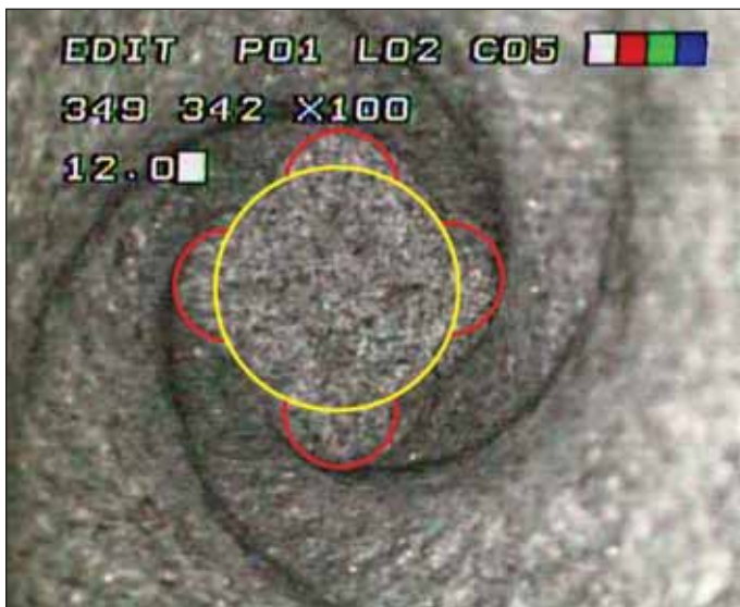
Obr. 5 Vzhled průřezu vrtu se „šroubovicí“ u čelby vrtu, kružnicí je vyznačen plánovaný průměr vrtu, černou barvou jsou naznačeny hranice vykaverno- vaných oblastí kmitáním vrtné korunky
