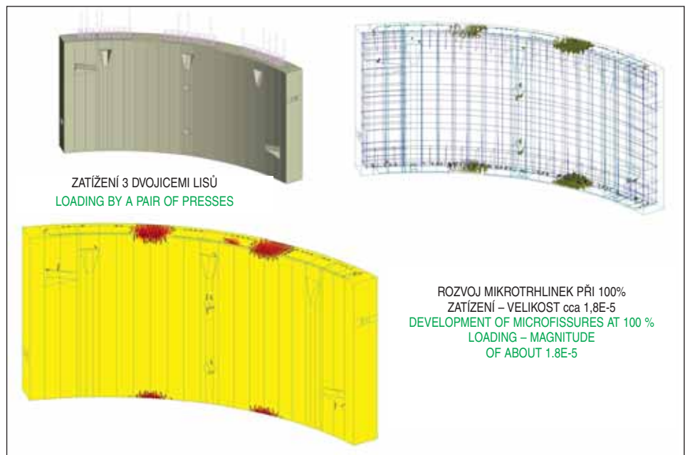
Obr. 9 Analýza 3D dílce při 100% zatížení od lisů stroje
