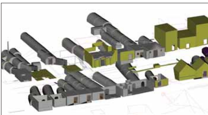
Obr. 11 Bořetice u Velkých Pavlovic – Kraví hora; zaměření a 3D zobrazení částí vinných sklepů dokumentuje jejich místní naprosté natěsnání, některé ze sklepů byly postupně a neřízeně prodlouženy až pod horní řadu lisoven
