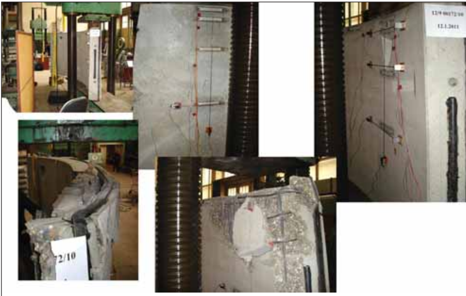
Obr. 11 Fotografie ze zatěžovací zkoušky dílce v Kloknerově ústavu ČVUT Praha; průběh rozvoje trhlinek při zkoušce odpovídal 3D modelu MKP; ke kolapsu došlo při vyšší úrovni zatížení Fig. 11 Photo taken during a segment loading test in the Klokner Institute of the Czech Technical University in Prague. The curve for the development of cracks during the test corresponded to the FEM 3D model; the segment collapsed under a higher level of loading
