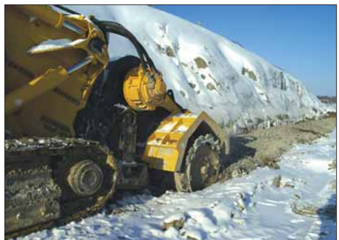
Obr. 7 Skalní fréza Fig. 7 Rock treacher
