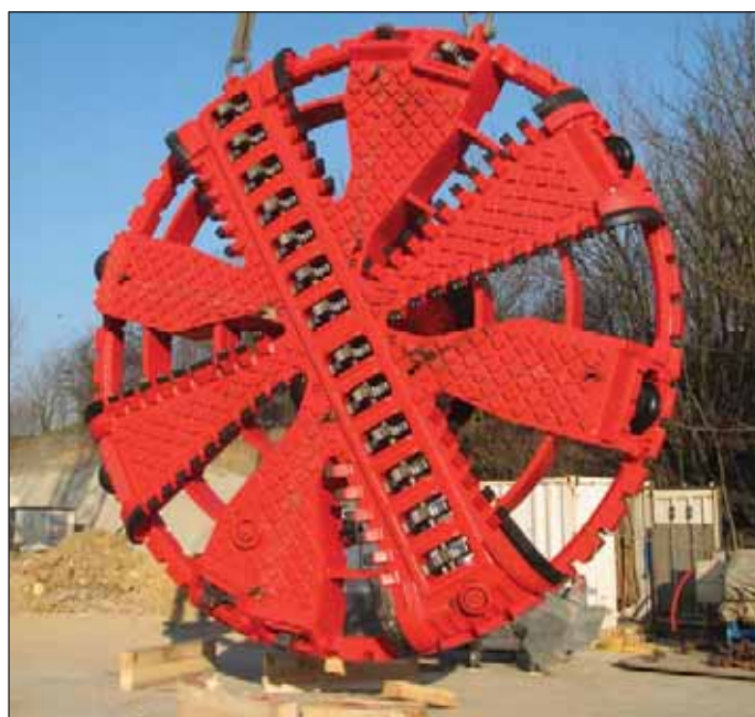
Obr. 4 Řezná hlava zeminového štítu S-609 (Tonda) Fig. 4 Cutting head of S-609 (Tonda) EPB shield
