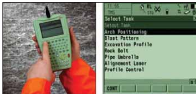
Obr. 3 Ďialkové ovládanie AVLS (Motorlasera) – riešenie firmy Amberg-Leica – Švajčiarsko. Autor – Manuál k programu TMS-Leica
