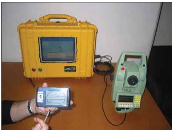
Obr. 2 Zostava kompletu AVLS (Motorlasera) – riešenie firmy Angermeier – SRN. Autor – Feraňčík
