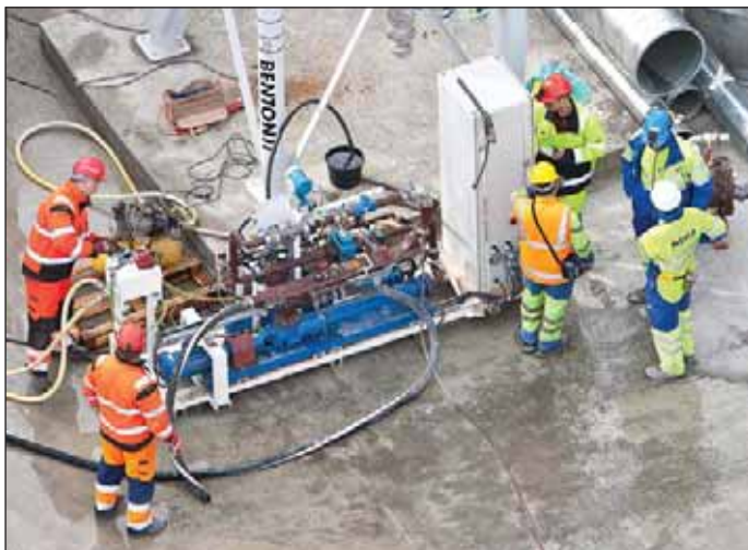
Obr. 8 Zkoušení dvoukomponentní výplňové malty na testovacím zařízení, které simuluje podmínky směšování komponenty A a B na tunelovací stroji (foto Jan Tatar)
