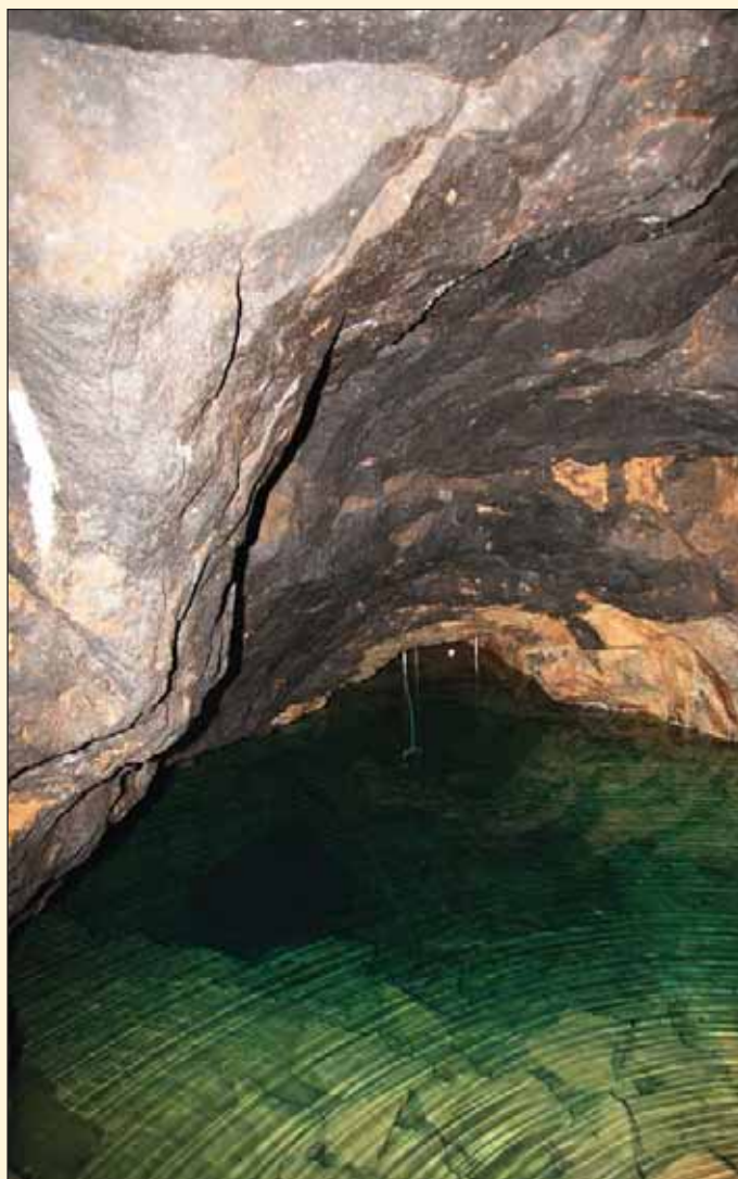
Obr. 7 Zatopené bezodtokové prostory pod úrovní štolového patra Fig. 7 Inundated spaces without outlet under the adit level
