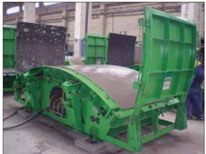
Obr. 5 Velmi přesná forma dodaná společností Herrenknecht Formwork Fig. 5 High-precision mould supplied by Herrenknecht Formwork
