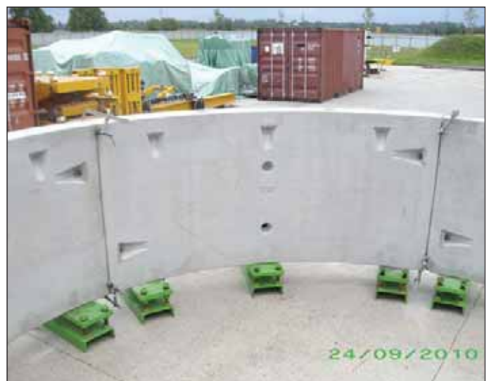
Obr. 4 Pokusný prstenec pro zkoušky rozměrů, smontovaný ve výrobě Herrenknecht Formwork
