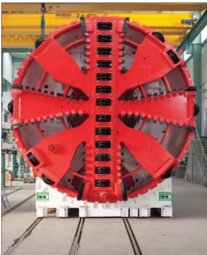
Obr. 2 Smontovaný zeminový štít o průměru 6,1 m pro prodloužení trasy A pražského metra v dílnách firmy Herrenknecht AS v Německu
