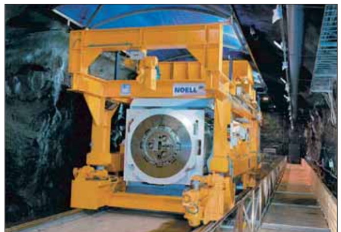
Obr. 3 Stroje pro ukládání kontejnerů s jaderným odpadem. Tlamsa 2003 Fig. 3 Machines used for the putting of containers with nuclear waste in place. Tlamsa 2003
