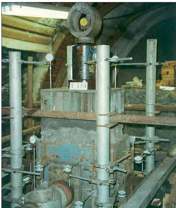
Obr. 7 Zkouška pevnosti v tříosém tlaku (návrh aparatury VUT Brno) na horninovém bloku průřezu 50 x 50 cm a výšky 100 cm, (rok 1996 – průzkumná štola pro tunel Mrázovka)
