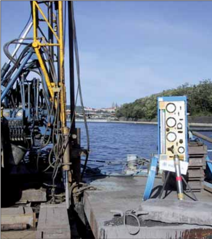
Obr. 7 Presiometrické zkoušky pod řečištěm Vltavy pro kolektor Hlávkův most (presiometr francouzské firmy APAGEO)
