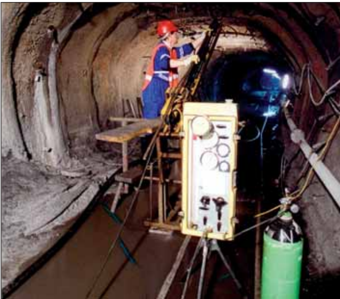
Obr. 3 Presiometrické zkoušky z průzkumné štoly Mrázovka (přístroj Ménéard – typ GA)
