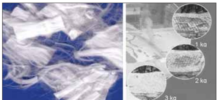
Obr. 7 Monofilamentní polypropylenová vlákna a stupeň povrchového odstřelování se zvýšením dávky na metr kubický betonu (s laskavým svolením ADFIL UK Ltd.)
