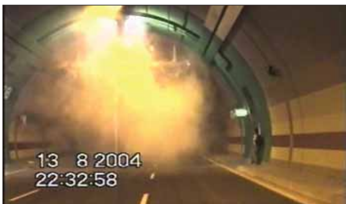
Obr. 6 Zkouška chladným kouřem Fig. 6 The cold smoke test
