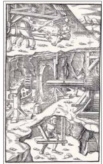
Obr. 3 Vyobrazení těžního stroje z knihy šesté G. Agricoly
