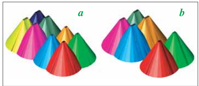
Obr. 12 Roznos zatížení od kontaktních ploch reálných vozidel a - čtyřnápravová Tatra T815, b - Tatra Jamal
