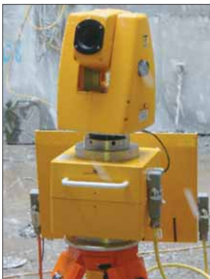
Obr. 2 TunnelBeamer™ s připevněným laptopem Fig. 2 TunnelBeamer™ with attached laptop computer
