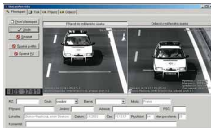
Obr. 3 Validace přestupků na pracovišti operátora dohledu Fig. 3 Validation of offence events at workplace of the supervising operator
