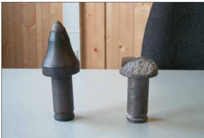
Obr. 6 Nové a opotřebované řezné nástroje po dvanácti hodinách práce Fig. 6 New and worn roadheader picks after 12hours work
