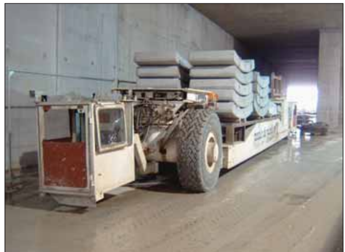
Obr. 13 Silniční dopravníky Paulo de Nicola pro přepravu dílců pro tunely HExEx
