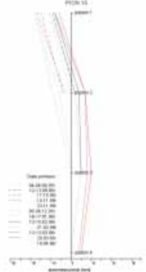
Obr. 4 Vodorovné posuny ve svislé řadě měření č. 15 Fig. 4 Setting-up of horizontal displacement measurements at No 15 vertical measurements line
