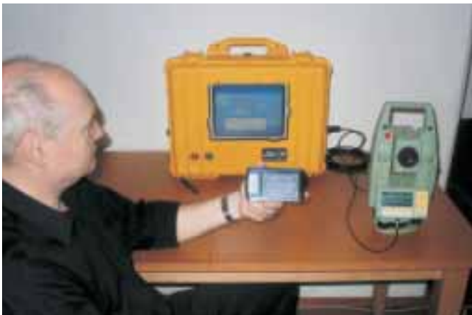
Obr. 3 Komplet AVLS - motorlasera novej generácie Fig. 3 New-generation ASLS - motorlaser set
