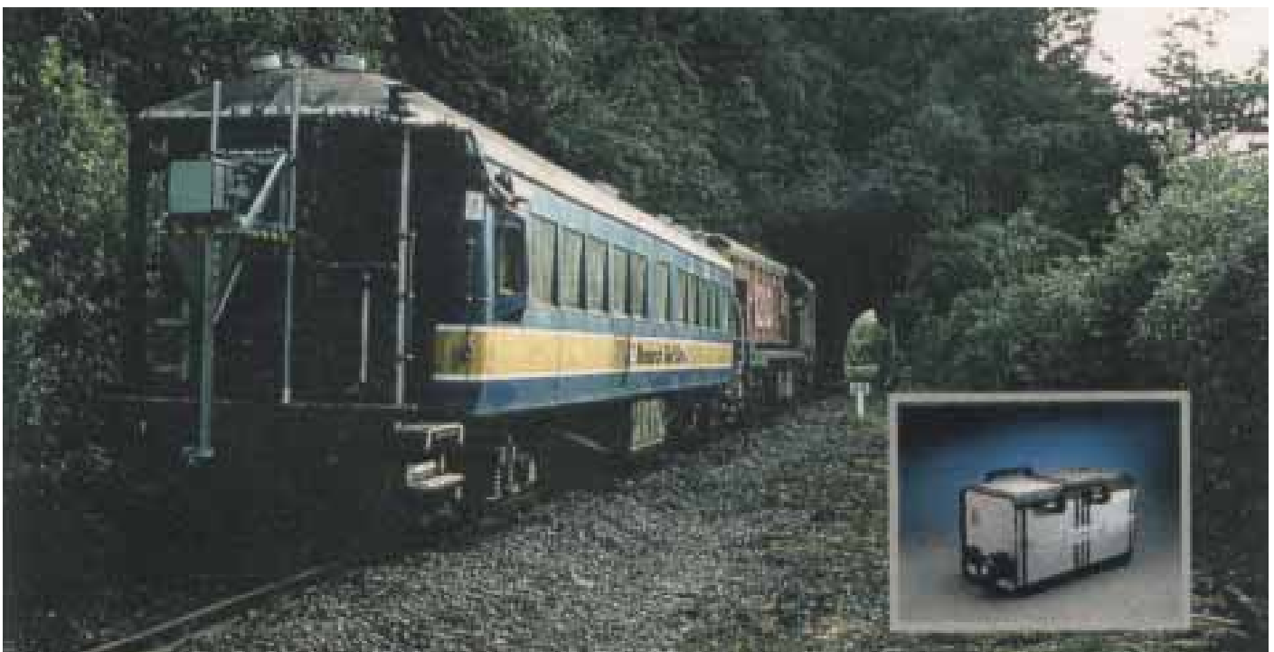
Obr. 1 Skener Spacotec TS 360 na měřicím voze Fig. 1 Spacotec TS 360 scanner on a measuring car
