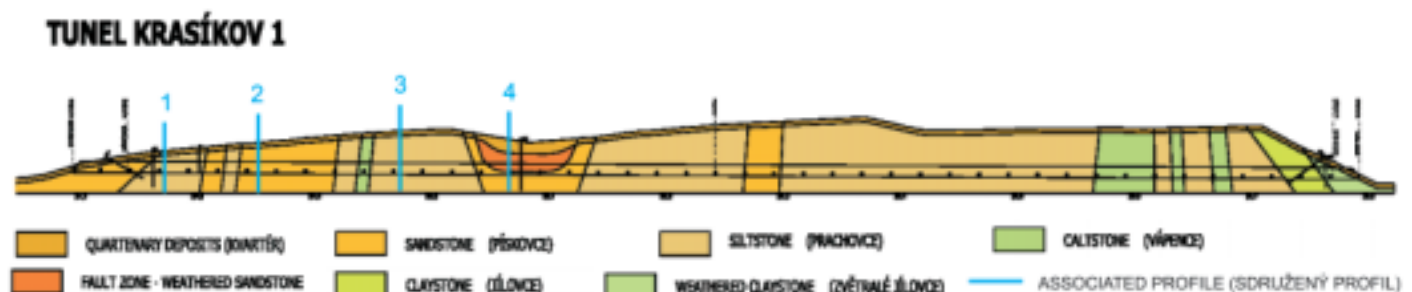
Obr. 1 Tunel Krasíkov I - zjednodušený geologický řez a sružené monitorovací profily Fig. 1 Krasíkov I tunnel - simplified geological profile and combined monitoring profiles
