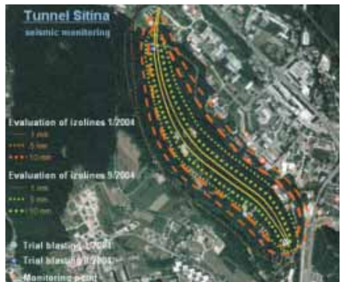
Obr. 2 Zóna vplyvu trhacích prác pri ekvivalentnej náloží 123 kg Fig. 2 Zone of influence of blasting at equivalent charge of 123 kg
